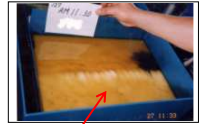
油水分離槽内の浮上油
